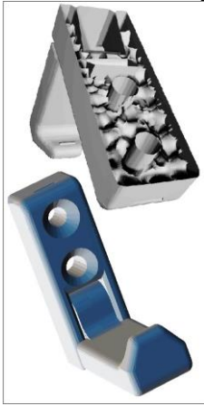
Рисунок 8. Приклади проектування моделей гачка (а) та друкування пористих структур (б)
