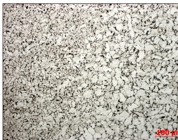
Мал. 11 – Структура зварного шва, зразок №5: а – ділянки неповного розплавлення та перегріву, б – перехід нормалізованої структури в основний метал
