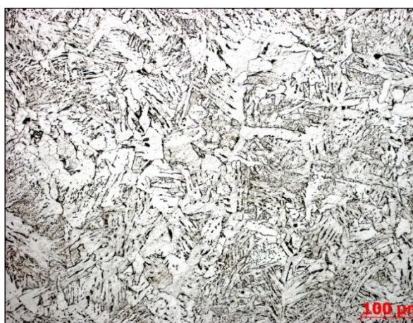
Мал. 11 – Структура зварного шва, зразок №5: а – ділянки неповного розплавлення та перегріву, б – перехід нормалізованої структури в основний метал
