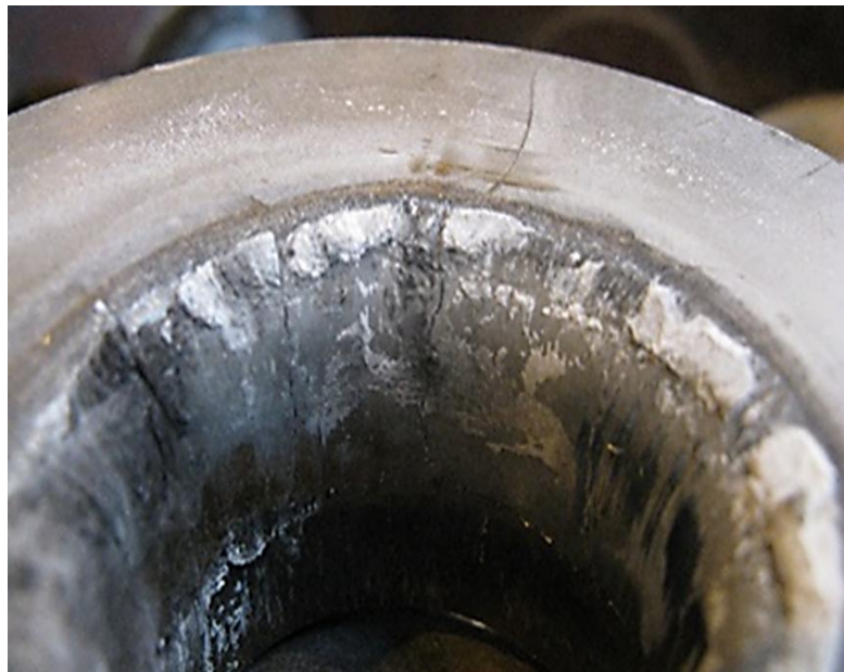
Рисунок 1. Фото зносу матриці трубопрофільного пресу
