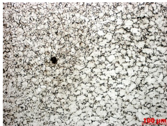
Мал. 9 – Структура зварного шва, зразок №4: а – перехід від ділянки перегріву до зони нормалізації, б – перехід нормалізованої структури в основний метал
