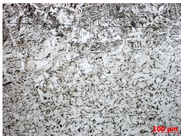
Мал. 9 – Структура зварного шва, зразок №4: а – перехід від ділянки перегріву до зони нормалізації, б – перехід нормалізованої структури в основний метал
