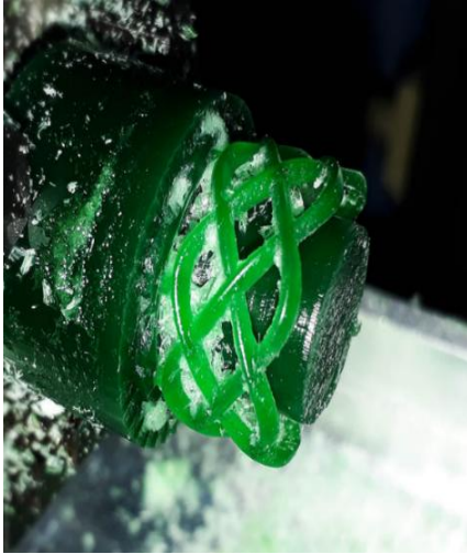
Рисунок 1 – Воскова модель каблучки, фрезерована на верстаті [ http://jewel-wax.com.ua/ ]
