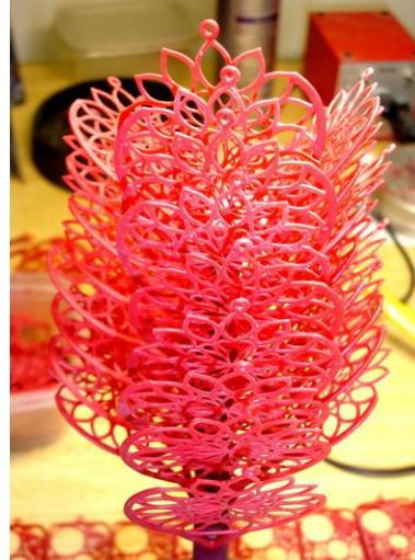
Риснок 2 – Воскова «ялинка», готова для формовки [ https://silver-ua.com/sozdanie-voskovej-yolki/ ]
