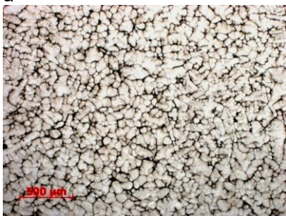
Рис. 2. Мікроструктура зразків: а) БЛЗ сталі №1 в центральній частині; б) при нагріві сталі №2 на 50 °С вище температури ліквідусу та охолодження зі швидкістю 10^2 °С/с; в) при нагріві на 150 °С вище температури ліквідусу та охолодження зі швидкістю 10^2 °С/с, \times 100
