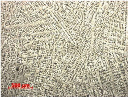
Рис. 1. Мікроструктура зразків: а) БЛЗ сталі №1 в центральній частині; б) при нагріві сталі №2 на 50 °С вище температури ліквідусу та охолодження зі швидкістю 10 °С/с; в) при нагріві сталі №2 на 150 °С вище температури ліквідусу та охолодження зі швидкістю 10 °С/с, \times 100
