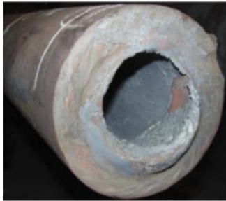
Рисунок 5. – Труба D×S=203 × 45 мм після прокатування на пілігримовому стані: а – задній кінець, б – передній кінець
