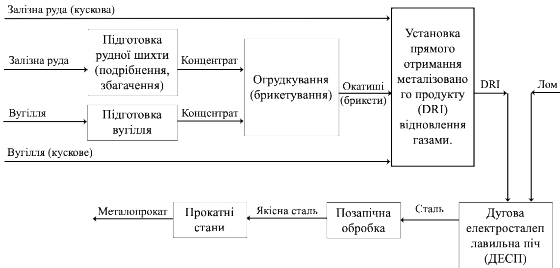
Рис. 1. Традиційна послідовність отримання продуктів твердофазного відновлення та їх використання для плавлення сталі.
