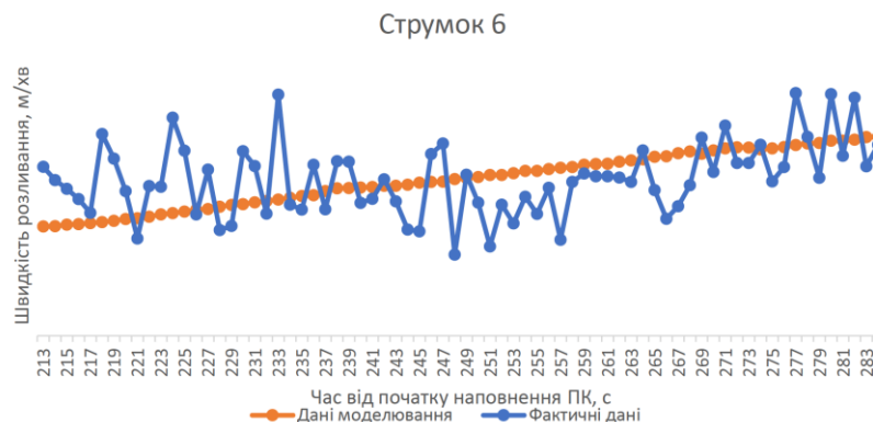
Рис.5. Порівняння фактичної швидкості розливання струмка №6 з даними моделювання
