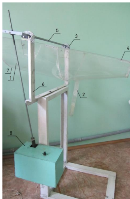
Рисунок 2. Загальний вигляд установки фізичної моделі конвертера в масштабі 1:6: 1 – корпус моделі із прозорого оргскла; 2 – лійка (сталевипускний канал); 3 – опорні цапфи; 4 – перекладки жорсткості; 5 – опорна вісь; 6 – вертикальні опори; 7 – днище; 8 – електромеханічний привід нахилу моделі конвертера.
