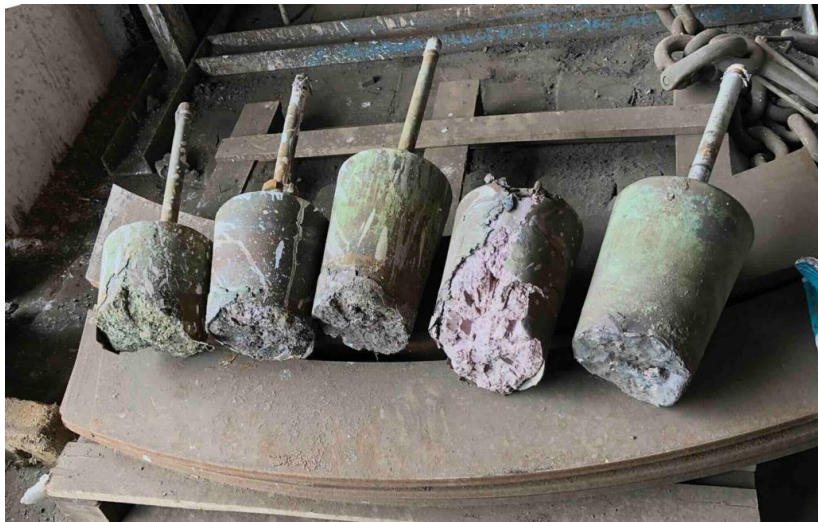
Рис. 3. Основні механізми зносу продувних пробок
