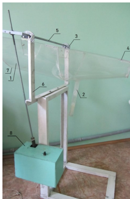
Рисунок 2. Загальний вигляд установки фізичної моделі конвертера в масштабі 1:6: 1 – корпус моделі із прозорого оргскла; 2 – льютка (сталевипускний канал); 3 – опорні цапфи; 4 – перекладки жорсткості; 5 – опорна вісь; 6 – вертикальні опори; 7 – днище; 8 – електромеханічний привід нахилу моделі конвертера.
