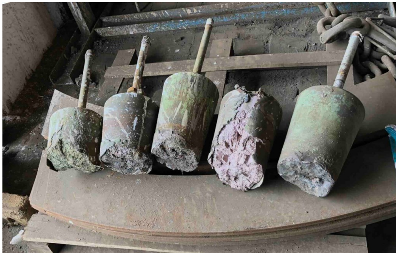
Рис. 3. Основні механізми зносу продувних пробок
