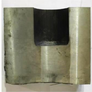
Рисунок 4. – Поздовжній переріз стакану в районі денця при прошивці БЛЗ на горизонтальному пресі 20 МН
