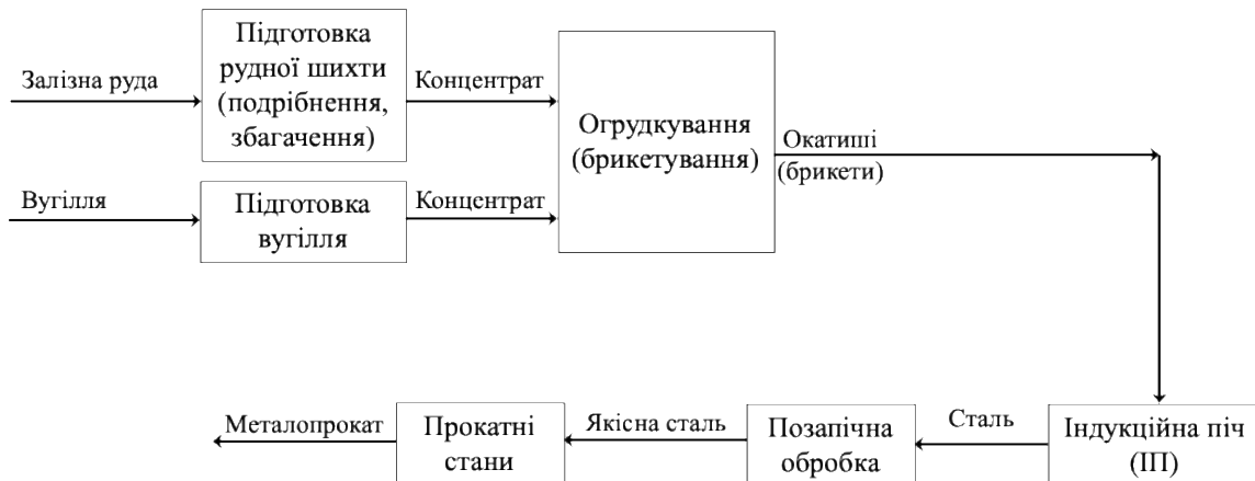
Рис. 2. Технологічна послідовність отримання сталевих продуктів з використанням індукційної печі та продуктів твердофазного відновлення.
