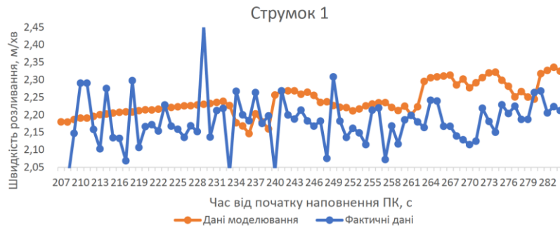
Рис.6 Порівняння фактичної швидкості розливання струмка №1 з даними моделювання
