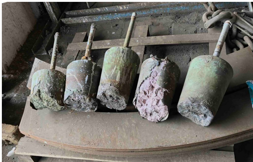
Рис. 3. Основні механізми зносу продувних пробок
