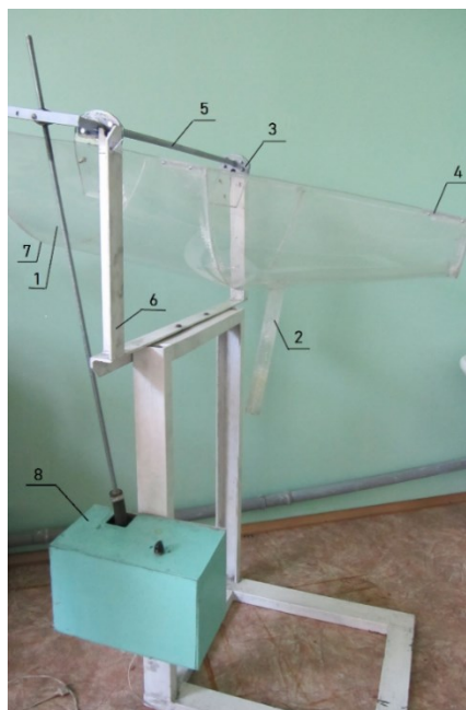
Рисунок 2. Загальний вигляд установки фізичної моделі конвертера в масштабі 1:6: 1 – корпус моделі із прозорого оргскла; 2 – лъотка (сталевипускний канал); 3 – опорні цапфи; 4 – перекладини жорсткості; 5 – опорна вісь; 6 – вертикальні опори; 7 – днище; 8 – електромеханічний привід нахилу моделі конвертера.
