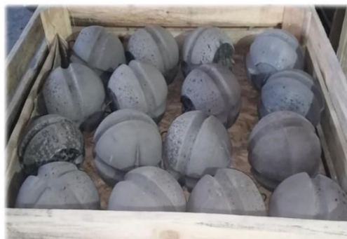
Рисунок 10. Стопор вторинного відсікання конвертерного шлаку марки «GIR-Ballstop-KS-250» ЧАО «КАМЕТ-СТАЛЬ»: а) схематичне зображення (креслення), б) зовнішній вигляд (пакування).
